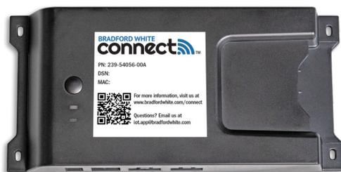
L'adaptateur doit se situer à moins de 1,5 m (5 pi) d'une prise de 120 V et être à portée du port Ethernet à l'avant du chauffe-eau. Le câble Ethernet fourni fait 2,13 m (7 pi) de long, mais un câble Ethernet (CAT5e) d'une longueur maximale de 30,48 m (100 pi) peut également fonctionner. Lors de l'installation, le bouton d'action et l'étiquette avant de l'adaptateur doivent rester visibles et facilement accessibles.
