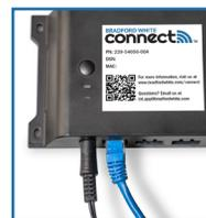
Branchez le câble d'alimentation électrique de 1,52 m (5 pi) du port de l'adaptateur à une source d'alimentation de 120 V.
